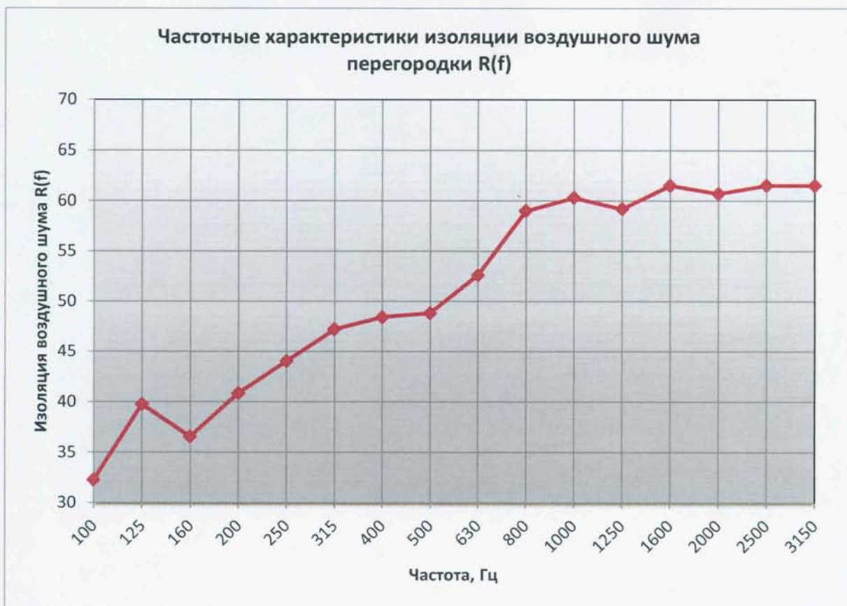
Рис. 2. Частотная характеристика изоляции воздушного шума конструкции перегородки системой Триплекс КСВ-51
